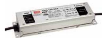
Alimentation LED de classe II avec correction du facteur de puissance dans un boîtier métallique IP65 100~305 VCA/48 VCC. Protection contre les courts-circuits, les surcharges et les surtensions. Câbles de connexion de 30 cm pré-assemblés. Efficacité: +/- 90%.
