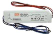
Alimentation LED de classe II avec correction du facteur de puissance dans un boîtier plastique IP67 90~264VAC/24VDC. Câbles de raccordement pré-assemblés de 30cm. Rendement de: +/-88%.
