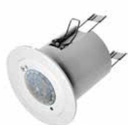
Capteur PIR Integraconnect ITC-PIRCEFL avec capteur intégré de lumière du jour pour les applications de bureau. Le capteur est adapté pour un montage encastré et est directement raccordé sur 240V. Convient pour une hauteur de montage jusqu'à 5 mètres. Zone de détection jusqu'à 7 mètres de diamètre.
