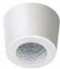
Les capteurs Integraconnect ITC-PIRWB et ITC-PIRNB avec capteur de lumière du jour intégré pour applications industrielles. Convient pour des hauteurs de montage jusqu'à 20 mètres et des zones de détection jusqu'à 28 mètres de diamètre. Des versions avec un faisceau de détection large ou étroit sont disponibles de même qu'une version IP66 pour les environnements humides
