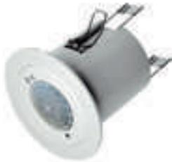
Integraconnect ITC-PIRCEFL capteur avec capteur de lumière du jour intégré pour les applications de bureau. Le capteur est adapté pour un montage encastré et est directement connecté à 240V. Convient pour une hauteur de montage jusqu'à 5 mètres. Zone de détection jusqu'à 7 mètres de diamètre.
