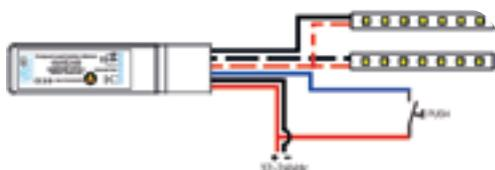
Interface Integraconnect ITC-MC2 avec deux sorties PWM pour les rubans-LED monochromes. Chaque canal peut être commandé séparément. Un bouton poussoir peut être directement raccordé sur l'interface pour marche/arrêt et régulation.
