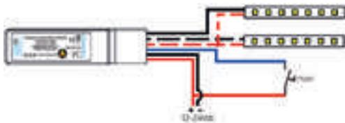
**Integraconnect ITC-MC2** est une interface avec deux sorties PWM pour rubans LED mono-couleur. Chaque canal peut être contrôlé indépendamment. Un bouton-poussoir peut être directement connecté à l'interface pour l'allumage/extinction et le dimming.
