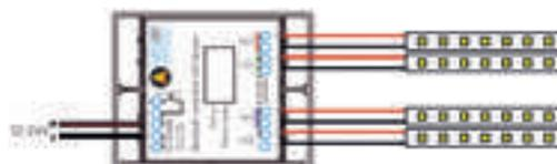
Interface Integraconnect ITC-CCT avec sortie PWM pour human centric lighting.
