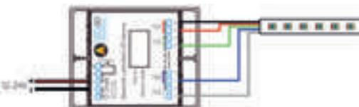
**Integraconnect ITC-RGB** est une interface avec sortie PWM pour rubans LED RGB.
