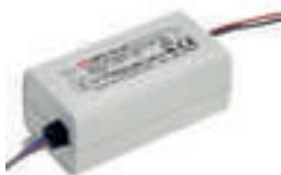
Alimentation de basse puissance de classe II dans un boîtier en plastique IP42 90~264 VCA/24 VCC. Cette alimentation doit être chargée à au moins 50 % et est donc moins adaptée à la gradation. Câbles de connexion de 15 cm pré-assemblés. Efficacité: +/- 84%.
