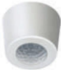
Integraconnect ITC-PIRWB & ITC-PIRNB capteurs avec capteur de lumière du jour intégré pour les applications industrielles. Convient pour des hauteurs de montage allant jusqu'à 20 mètres et des zones de détection jusqu'à 28 mètres de diamètre. Des versions avec faisceau de détection large ou étroit sont disponibles, ainsi qu'une version IP66 pour les environnements humides.
